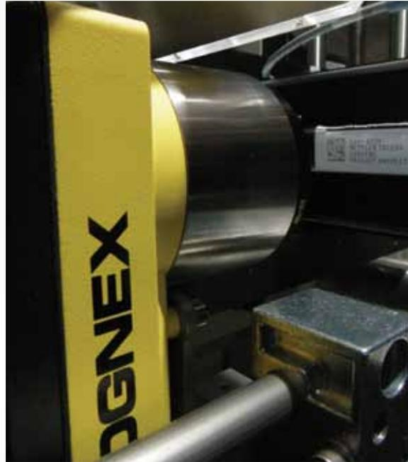
à grande vitesse. Grâce à la combinaison de capteurs, d'une architecture à base d'un processeur et d'un logiciel d'identification optimisé, les lecteurs fixes In-Sight peuvent répondre aux exigences de la production à grande vitesse tout en assurant une lecture très précise.
